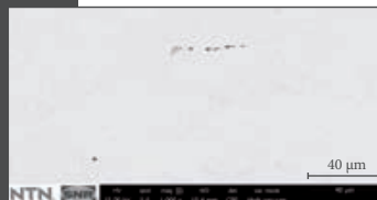
Vistas con MEB de inclusiones de aluminato tomadas a la misma escala
